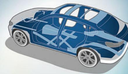
■ Die **Fahrgastzelle** bietet durch die funktional ausgelegte Struktur mit speziellen Trägerverläufen und Knotenverbindungen sowie den gezielten Einsatz von hochfesten Materialien ein Optimum an passiver Sicherheit im Falle eines Front-, Seiten- und Heckcrashes.
