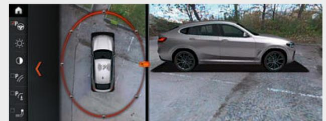
□ Die Surround View<sup>8</sup> bietet die kamerabasierten Funktionen Rückfahrkamera, Top View, Panorama View, 3D View und Remote 3D View<sup>9</sup>. Kameras in den Außenspiegeln, an Front und Heck ermöglichen einen 360°-Rundumblick. Die Panorama View macht das Herantasten an Kreuzungen und Ausfahrten sicherer. Sie zeigt auf dem Control Display die Situation rechts und links vom Fahrzeug an.
