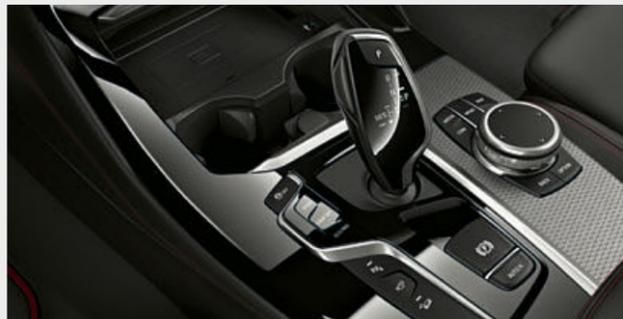
Das 8-Gang Steptronic Sport Getriebe ermöglicht sehr sportliche Gangwechsel. Sowohl automatisch als auch manuell per Wählhebel oder Schaltwippen – für komfortables Gleiten oder eine sehr dynamische Fahrweise. Im Modus SPORT und mit dem Wählhebel in der linken Schalthebelgasse S/M sind die Schaltabläufe für höchste Performance ausgelegt.
