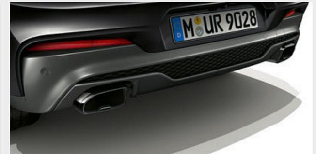
Das M Aerodynamikpaket unterstreicht optisch die Sportlichkeit des Fahrzeugs und optimiert die Luftführung. Es beinhaltet eine Frontschürze mit vergrößerten Lufteinlässen, spezifische Seitenschweller, Claddings und Radlaufblenden sowie eine Heckschürze mit Diffusoreinsatz.
