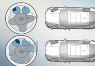
■ Die **Variable Sportlenkung** mit Servotronic sorgt für ein direktes und agiles Fahrverhalten bei geringerem Lenkaufwand. Sie reagiert mit unterschiedlichen Lenkübersetzungen auf den Lenkradeinschlag. Dabei verbessert sie das Handling bei sportlicher Fahrweise und reduziert den Lenkaufwand beim Einparken und Abbiegen.
