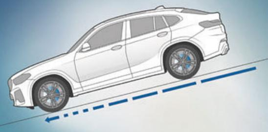
■ Die Ausstattung **Hill Descent Control** der xDrive Modelle ist eine Bergabfahrkontrolle, die bei Aktivierung dafür sorgt, dass das Fahrzeug selbst steile Bergabpassagen automatisch und sicher mit etwas mehr als Schrittgeschwindigkeit bewältigt – ohne dass der Fahrer bremsen muss.
