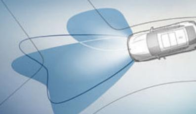
□ Der **Adaptive LED-Scheinwerfer** beinhaltet eine Abblend- und blendfreie Fernlichtfunktion (BMW Selective Beam) sowie Fahrtrichtungsanzeiger in Voll-LED-Technologie. Außerdem umfasst die Ausstattung Abbiegelicht, Tagfahrlicht und Adaptive Kurvenlicht mit variabler Lichtsteuerung für eine optimale Ausleuchtung der Fahrbahn und bessere Sicht bei Dunkelheit.
