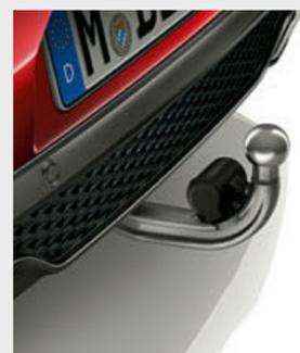
□ Die Anhängerkupplung mit elektrisch schwenkbarem Kugelkopf und Anhänger-Stabilitätskontrolle ist für hohe Anhängelasten bis zu 2.400 kg zugelassen.
