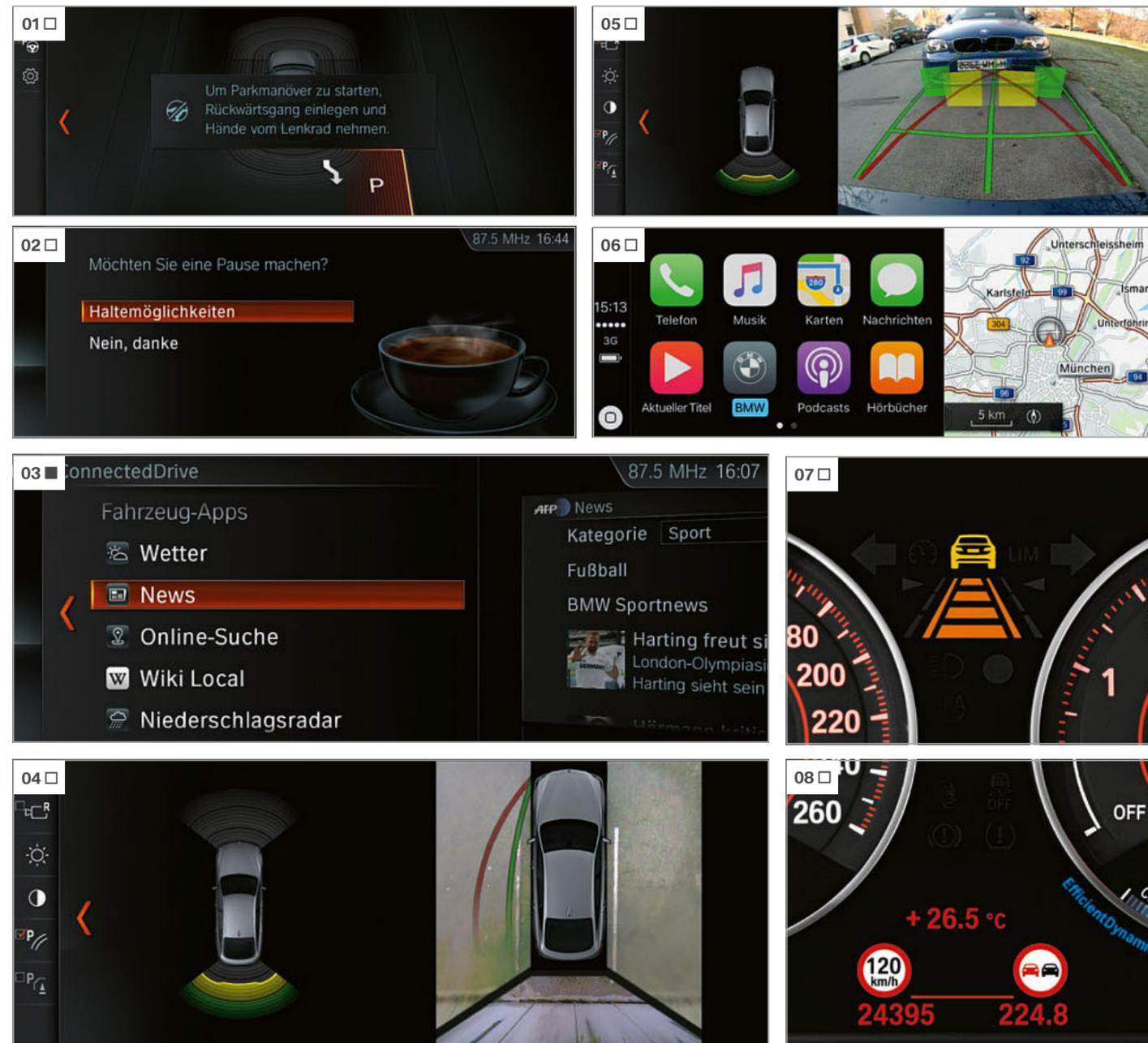
**[ 01 ]** Der Parkassistent erleichtert das Einparken parallel und quer zur Fahrbahn. Er lenkt, während der Fahrer Gas gibt, bremsst und schaltet.
