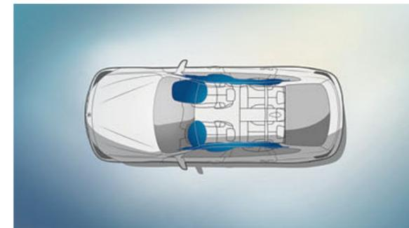
■ Die **Airbags für Fahrer und Beifahrer** sowie die in den Vordersitzlehnen integrierten Seitenairbags bieten gezielten Schutz im Falle eines Unfalls.
