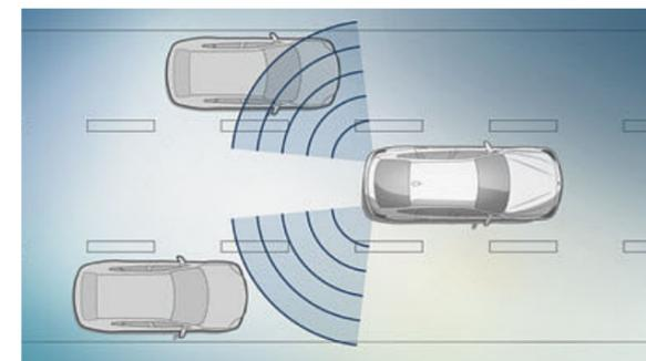
□ Die **Spurwechselwarnung<sup>1</sup>** warnt den Fahrer beim Spurwechsel optisch und per Lenkradvibration vor Fahrzeugen im toten Winkel bzw. auf der Nachbarspur.
