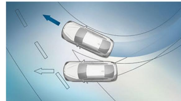
■ Die **Dynamische Stabilitäts Control (DSC)** mit erweiterten Umfängen stabilisiert das Fahrzeug, sobald es eine Schleuderneigung erkennt.
