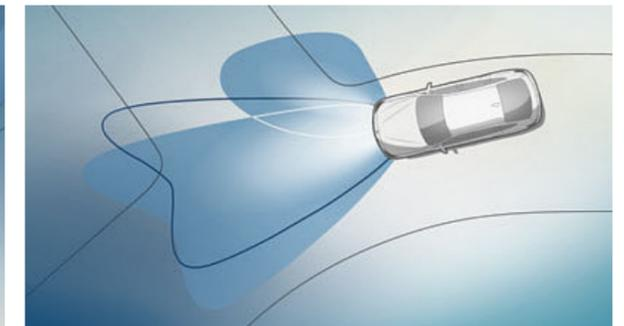
□ Der **Adaptive LED-Scheinwerfer** mit tageslichtähnlicher Lichtfarbe passt seine Lichtverteilung automatisch an die Geschwindigkeit und den Lenkeinschlag an.
