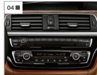
**[ 04 ]** Die Klimaautomatik mit 2-Zonenregelung sowie automatischer Temperaturregelung können Fahrer und Beifahrer getrennt regulieren. Enthalten sind eine Automatische Umluft Control (AUC), ein Mikroaktivkohlefilter, ein Beschlag- und Solarsensor sowie Fondausströmer.
