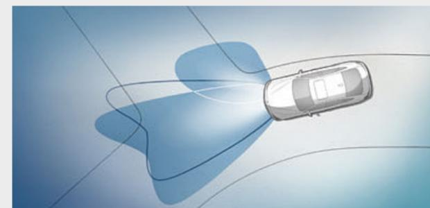
□ Der **Adaptive LED-Scheinwerfer** passt seine Lichtverteilung an die Geschwindigkeit und den Lenkeinschlag an. Er leuchtet die Fahrbahn optimal aus, verbessert die Sicht bei Dunkelheit und verfügt über zahlreiche Funktionen: Akzentleuchten, Leuchtringe, Abblendfunktion, BMW Selective Beam, Nebelscheinwerfer, Abbiegelicht, Blinker, Tagfahrlicht und Adaptives Kurvenlicht.
