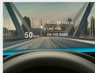
□ Das vollfarbige BMW Head-Up Display<sup>4</sup> blendet per optischer Projektion für die Fahrt relevanten Daten in das Sichtfeld des Fahrers ein.
