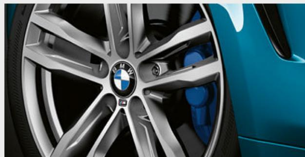
□ Die M Sportbremse<sup>2</sup> mit Vierkolben-Festsattel vorn und Zweikolben-Faustsattel hinten in Dunkelblau sowie mit M Schriftzug verfügt über größere Bremsscheiben und damit über eine besonders hohe Bremsleistung.
