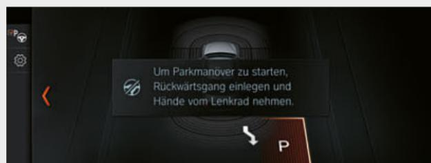
□ Der Parkassistent<sup>6</sup> erleichtert das Einparken parallel und quer zur Fahrbahn. Dazu misst das System auch enge Längsparklücken beim Vorbeifahren mit niedrigem Tempo aus. Ist eine ausreichend große Lücke gefunden, übernimmt der Parkassistent das Lenken und der Fahrer begleitet den Einparkvorgang durch die richtige Gangwahl sowie das Gasgeben bzw. Bremsen.
