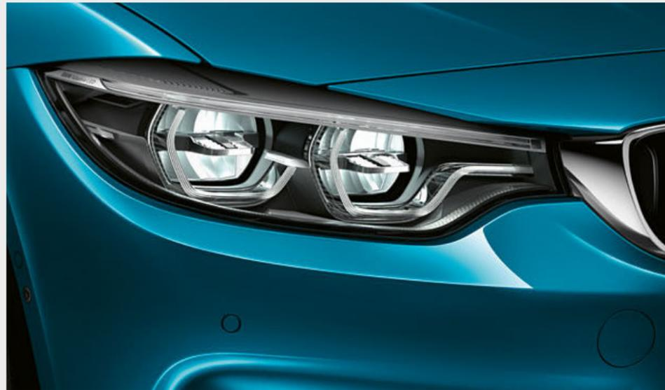
□ Der Adaptive LED-Scheinwerfer passt seine Lichtverteilung an die Geschwindigkeit und den Lenkeinschlag an. Er leuchtet die Fahrbahn optimal aus, verbessert die Sicht bei Dunkelheit und verfügt über zahlreiche Funktionen: Akzentleuchten, Leuchtringe, Abblendfunktion, BMW Selective Beam, Nebelscheinwerfer, Abbiegelicht, Blinker, Tagfahrlicht und Adaptives Kurvenlicht.
