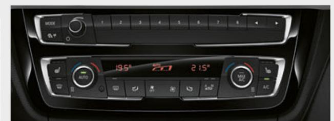
■ Die Klimaautomatik mit 2-Zonenregelung sowie automatischer Temperaturregelung können Fahrer und Beifahrer getrennt regulieren. Enthalten sind eine Automatische Umluft Control (AUC), ein Mikroaktivkohlefilter, ein Beschlag- und Solarsensor sowie Fondausströmer.
