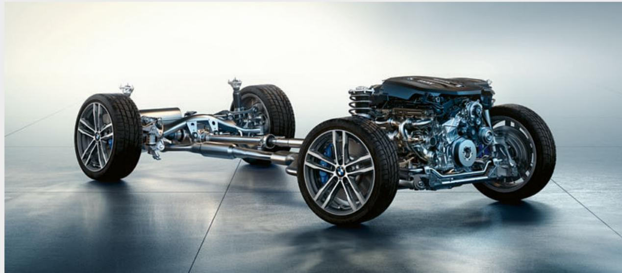
Die **Variable Sportlenkung**<sup>1</sup> mit Servotronic sorgt für ein direktes und agiles Fahrverhalten bei geringerem Lenkaufwand. Sie reagiert mit unterschiedlichen Lenkübersetzungen auf den Lenkradeinschlag. Dabei verbessert sie das Handling bei sportlicher Fahrweise und reduziert den Lenkaufwand beim Einparken und Abbiegen. Zusätzlich ergänzt der wählbare Modus SPORT+ die Ausstattung.
