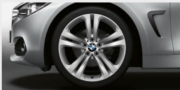
□ 19" Leichtmetallräder Doppelspeiche 401 mit Mischbereifung, Größe vorn 8J x 19, Bereifung 225/40 R19, Größe hinten 8,5J x 19, Bereifung 255/35 R19.
