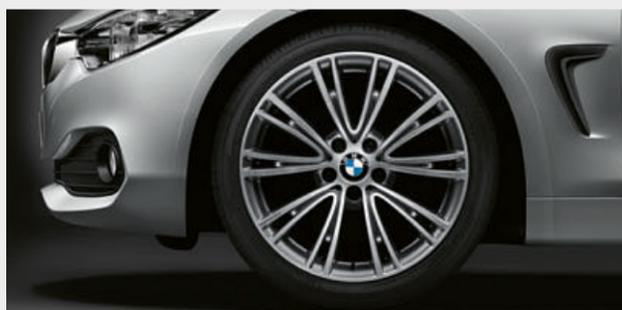
□ 19" Leichtmetallräder V-Speiche 626 I mit Mischbereifung, Größe vorn 8,5J x 19, Bereifung 225/40 R19, Größe hinten 8,5J x 19, Bereifung 255/35 R19.
