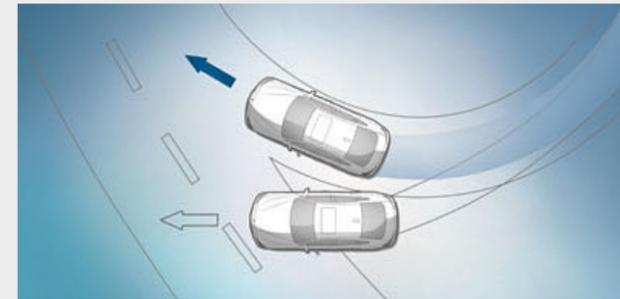
■ Die **Dynamische Stabilitäts Control (DSC)** mit erweiterten Umfängen stabilisiert das Fahrzeug, sobald es eine Schleuderneigung erkennt. Die erweiterten Umfänge sind Cornering Brake Control (CBC), Anfahr- und Bremsassistent, Trockenbremsen und Bremsbereitschaft. Für noch sportlicheres Fahren erlaubt die Unterfunktion Dynamische Traktions Control (DTC) erhöhten Radschlupf.
