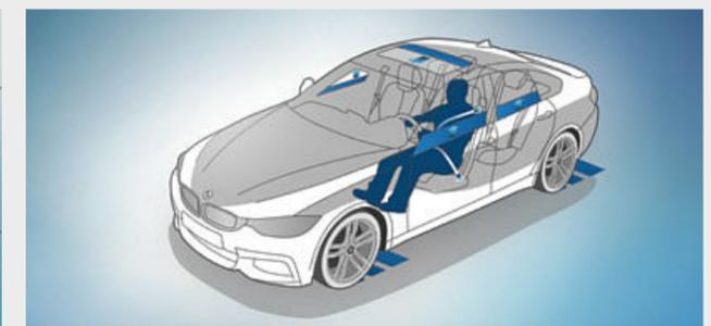
□ **Active Protection** ist der präventive Insassenschutz von BMW ConnectedDrive. Es warnt bei Müdigkeit, in kritischen Situationen werden die Sicherheitsgurte vorgespannt, elektrische Sitze in eine aufrechte Position gebracht<sup>3</sup> sowie Fenster und das Schiebedach geschlossen. Nach einem Unfall wird das Fahrzeug automatisch bis zum Stillstand abgebremst.
