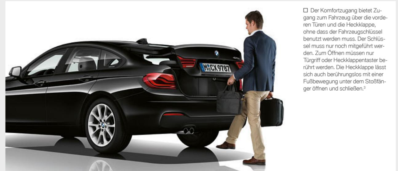
□ Der Komfortzugang bietet Zugang zum Fahrzeug über die vorderen Türen und die Heckklappe, ohne dass der Fahrzeugschlüssel benutzt werden muss. Der Schlüssel muss nur noch mitgeführt werden. Zum Öffnen müssen nur Türgriff oder Heckklappentaster berührt werden. Die Heckklappe lässt sich auch berührungslos mit einer Fußbewegung unter dem Stoßfänger öffnen und schließen.<sup>3</sup>
