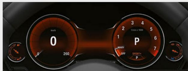
□ Das Multifunktionale Instrumentendisplay<sup>3</sup> in Black-Panel-Technologie und mit 8,8" Bildschirmdiagonale bietet eine beeindruckende visuelle Inszenierung des Fahrerlebnisses. Drei verschiedene Modi und deren spezifische Anzeigen, jeweils farblich und grafisch angepasst, lassen sich in der Instrumentenkombination anzeigen: ECO PRO, COMFORT und SPORT.
