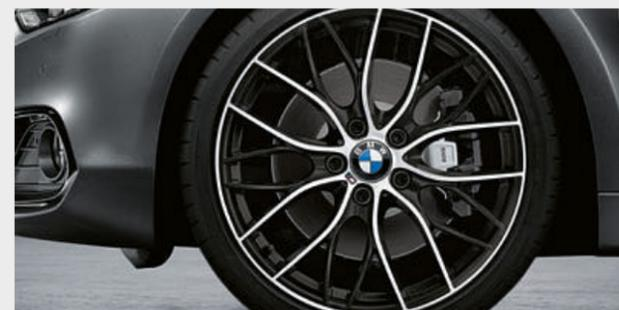
○ Geschmiedete 20" M Performance Leichtmetallräder Doppelspeiche 405M in Bicolor Orbitgrau, sichtbar glanzgedreht. RDC-Komplettradsatz mit Runflat-Mischbereifung.
