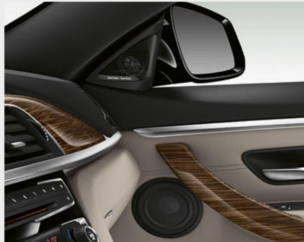
□ Das klanglich herausragende Harman Kardon Surround Sound System zeichnet sich durch einen 600-Watt-Digitalverstärker, 9 Kanäle und 16 Lautsprecher<sup>1</sup> mit Chromapplikation aus. Es erzeugt ein differenziertes Klangbild mit raumfüllendem Klang. Ein fahrzeugspezifisches und geschwindigkeitsabhängiges Equalizing kompensiert feinfühlig den Einfluss von Fahrgeräuschen.
