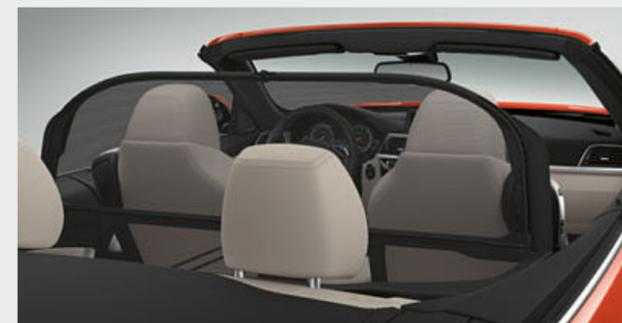
□ Der Windschutz<sup>4</sup> schützt Fahrer und Beifahrer auch bei hohen Geschwindigkeiten wirksam vor Zugluft im Schulter- und Nackenbereich. Wird er nicht benötigt, lässt er sich dank der klappbaren Seitenteile einfach zusammenfallen und bei geringem Platzbedarf mühelos verstauen.
