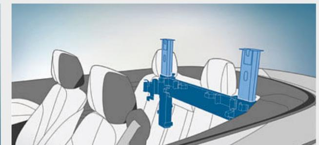
■ Das **Überrollschutzsystem**<sup>4</sup> in den Fond-Kopfstützen bildet zusammen mit dem in den Frontscheibenrahmen integrierten Überrollbügel die „Insassenzelle“. Bei einem Unfall fahren die in die Kopfstützen integrierten Schutzbügel in Sekundenbruchteilen aus und verbessern so bei einem Überschlag den Kopfschutz deutlich – für ein Plus an Sicherheit.
