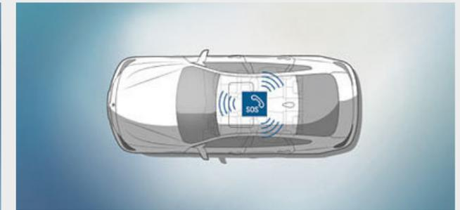
■ Der **Intelligente Notruf** stellt bei Bedarf automatisch über das BMW Callcenter die Verbindung zur nächsten Rettungsleitstelle her – unabhängig von einem privaten Mobiltelefon. Neben der aktuellen Fahrzeugposition werden zusätzlich Daten über die Unfallschwere übermittelt. Der Intelligente Notruf lässt sich auch manuell auslösen, um z. B. anderen Verkehrsteilnehmern zu helfen.
