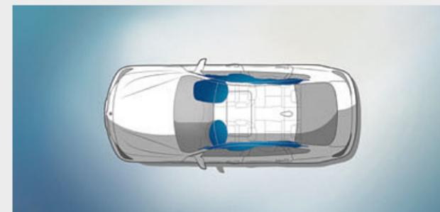
■ Die **Airbags** für Fahrer und Beifahrer sowie die in den Vorder- und Beifahrersitzen integrierten Seitenairbags sind Bestandteil der optimal aufeinander abgestimmten Sicherheitskomponenten in einem BMW und bieten gezielten Schutz im Falle eines Unfalls.
