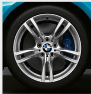
□ 18" M Leichtmetallräder Sternspeiche 400 M mit Mischbereifung<sup>1</sup>, Größe vorn 8J x 18, Bereifung 225/45 R18, Größe hinten 8,5J x 18, Bereifung 255/40 R18.
