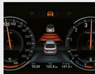
□ Die Aktive Geschwindigkeitsregelung mit Stop&Go-Funktion<sup>5</sup> hält eine vorgegebene Wunschgeschwindigkeit sowie den Abstand zum Vordermann.
