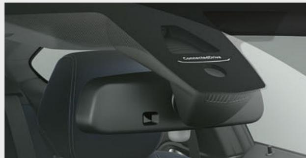
■ Der Regensensor schaltet bei Bedarf automatisch die Scheibenwischer ein und regelt je nach Stärke des Regens selbsttätig die Wischfrequenz. Abhängig von den Lichtverhältnissen aktiviert die dazugehörige Fahrlichtautomatik darüber hinaus das Abblendlicht.
