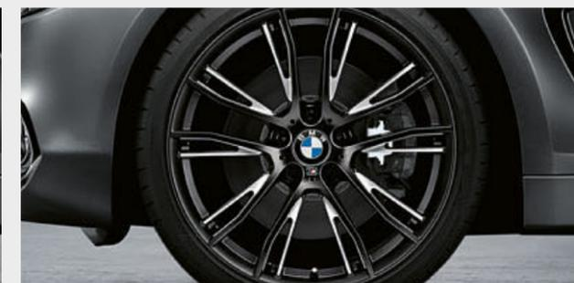
○ 20" Leichtmetallräder Doppelspeiche 624M in Bicolor Schwarz, sichtbar glanzgedreht. Komplettradsatz mit Runflat-Mischbereifung, Radgröße 8J x 20 vorn und 8,5J x 20 hinten.
