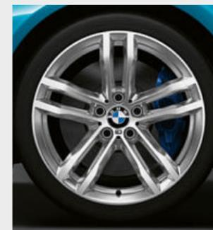
□ 19" M Leichtmetallräder Doppelspeiche 704 M Bicolor Ferricgrau mit Mischbereifung, hochglanzgedreht, Größe vorn 8J x 19, Bereifung 225/40 R19, Größe hinten 8,5J x 19, Bereifung 255/35 R19.
