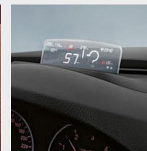
○ Das vollfarbige BMW Head-Up Display blendet per optischer Projektion für die Fahrt relevanten Daten in das Sichtfeld des Fahrers ein.
