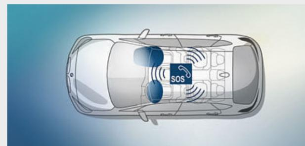
■ Der **Intelligente Notruf** stellt bei Bedarf automatisch über das BMW Callcenter die Verbindung zur nächsten Rettungsleitstelle her – unabhängig von einem privaten Mobiltelefon. Neben der aktuellen Fahrzeugposition werden zusätzlich Daten über die Unfallschwere übermittelt. Der Intelligente Notruf lässt sich auch manuell auslösen, um z. B. anderen Verkehrsteilnehmern zu helfen.
