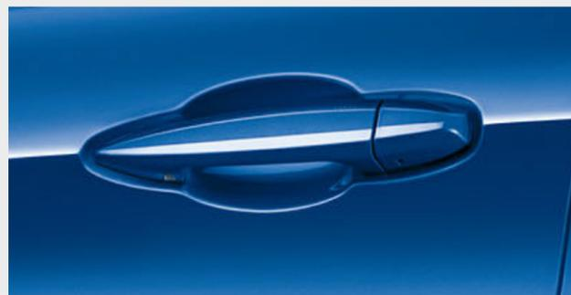
□ Der Komfortzugang bietet Zugang zum Fahrzeug über die vorderen Türen und die Heckklappe, ohne dass der Fahrzeugschlüssel benutzt werden muss. Der Schlüssel muss nur noch mitgeführt werden, etwa in der Hosentasche. Zum Öffnen ist es dann nur noch erforderlich, den Türgriff oder Heckklappentaster zu berühren.
