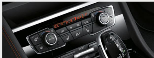
□ Die Klimaautomatik mit 2-Zonenregelung<sup>2</sup> sowie automatischer Temperaturregelung können Fahrer und Beifahrer getrennt regulieren. Enthalten sind eine Automatische Umluft Control (AUC), ein Mikroaktivkohlefilter, ein Beschlag- und Solarsensor sowie Fondausströmer.
