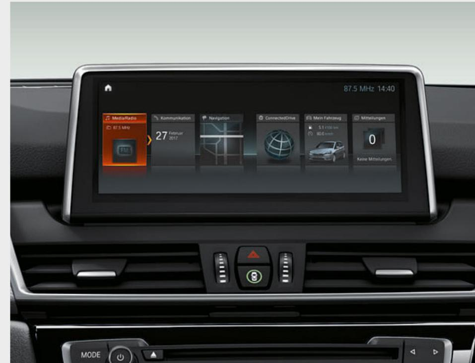
□ Die Navigation Plus<sup>3</sup> verfügt über ein BMW Head-Up Display<sup>1</sup>, einen iDrive Touch Controller, ein feststehendes 8,8" Touch-Display und eine Instrumentenkombination mit hochauflösendem 5,7" TFT-Display. Bedient wird das System intuitiv über den iDrive Touch Controller, über Direktwahl- und sechs bzw. acht Favoritentasten, per Spracheingabe oder über den Touchscreen mit interaktiven Kacheln.
