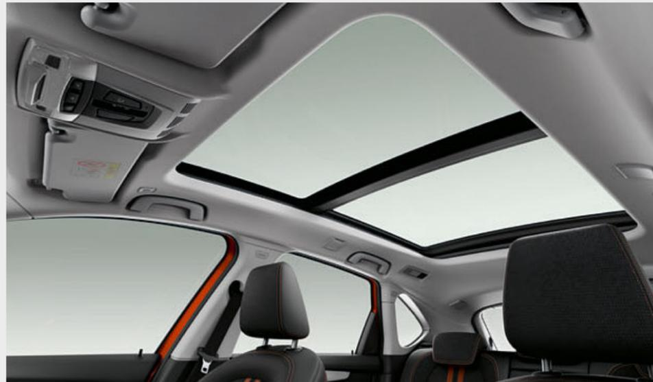
□ Das Panorama-Glasdach bietet geöffnet viel frische Luft und sorgt auch geschlossen für eine freundliche, lichtdurchflutete Atmosphäre im Fahrzeuginnenraum. Es öffnet und schließt sich auf Knopfdruck oder per Funkfernbedienung vollautomatisch und ist mit einer Schiebe- und Hebefunktion sowie einem Sonnenschutzrollo und Windabweiser ausgestattet.
