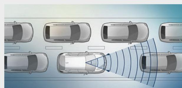
□ Der **Stauassistent**<sup>4</sup> entlastet Sie in eintönigen Verkehrssituationen auf der Autobahn: Das System erlaubt, im dichten Verkehr bei Geschwindigkeiten von bis zu 60 km/h „mitzuschwimmen“ und so entspannter durch den Stau zu kommen. Es hält automatisch den Abstand, regelt die Geschwindigkeit selbsttätig bis zum Stillstand und unterstützt Sie bei der Lenkung.
