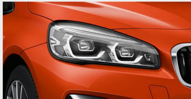
□ Der Adaptive LED-Scheinwerfer beinhaltet eine Abblend- und Fernlichtfunktion sowie Fahrtrichtungsanzeiger in Voll-LED-Technologie. Außerdem umfasst die Ausstattung BMW Selective Beam, Abbiegelicht, Tagfahrlicht und Adaptives Kurvenlicht mit variabler Lichtsteuerung für eine optimale Ausleuchtung der Fahrbahn und bessere Sicht bei Dunkelheit.
