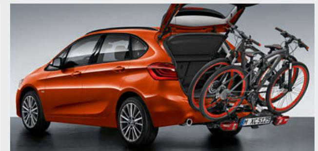
○ Der faltbare **Fahrradheckträger Kompakt** ist leicht, aber dennoch stabil und mit bis zu 60 kg belastbar. Er lässt sich schnell und sicher auf dem Kugelkopf montieren und nimmt zwei Fahrräder/E-Bikes auf. Zusammengeklappt lässt er sich spritzgeschützt und crashtolerant in der Gepäckraumwanne verstauen.
