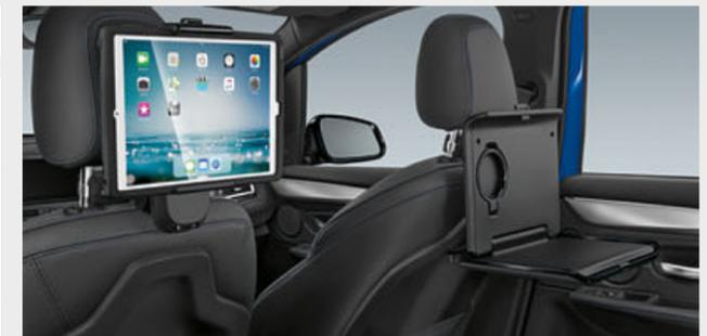
○ Der Universalhalter ist in der Größe verstellbar und wird im separat erhältlichen Basisträger des **Travel & Comfort Systems** eingerichtet. Er bietet sicheren Halt für viele Apple bzw. Samsung Tablets mit Travel & Comfort Tablet Safety Case von 7 bis 11 Zoll und lässt sich dank des um 360° drehbaren Rahmens mit Neigungsverstellung stets in der gewünschten Position feststellen.
