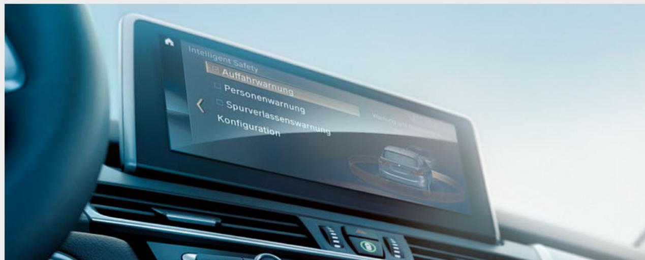
Das Sicherheitspaket **Driving Assistant**<sup>1,2</sup> enthält kamerabasierte Assistenzsysteme wie die Spurverlassenswarnung, Auffahrwarnung, Fernlichtassistent und Speed Limit Info. Die Auffahr- und Personenwarnung mit City-Anbremsfunktion warnt zwischen 10 und 60 km/h vor einer Kollision, die Spurverlassenswarnung warnt ab 70 km/h per Lenkradvibration vor dem Verlassen der Fahrspur.
