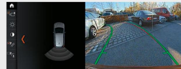
□ Die Rückfahrkamera ermöglicht Ihnen eine bessere Orientierung beim Rückwärtsfahren in Parksituationen und im Geschwindigkeitsbereich von unter 15 km/h. Sie zeigt den Bereich hinter dem Fahrzeug auf dem Control Display an. Interaktive Spurlinien für Abstand und Wendekreis unterstützen Sie beim Rangiervorgang, Hindernisse werden farblich gekennzeichnet.
