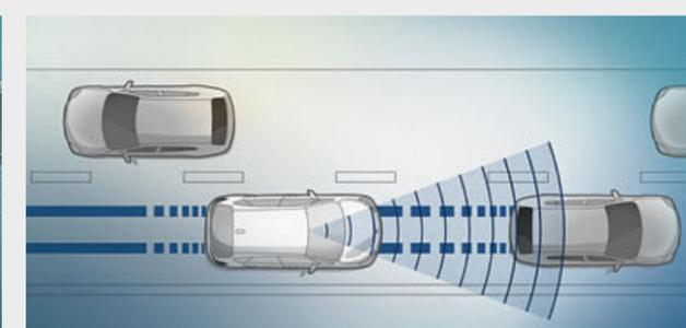
■ Die **Auffahrwarnung mit City-Anbremsfunktion**<sup>1,3</sup> warnt vor kritischen Auffahrsituationen und kann somit Unfälle verhindern. Bei Kollisionsgefahr mit einem vorausfahrenden oder stehenden Fahrzeug erfolgt eine zweistufige Warnung, gegebenenfalls werden die Bremsen für ein schnelleres Ansprechen vorkonditioniert. Im Notfall leitet das System eine Bremsung ein und sorgt für eine deutliche Verringerung der Aufprallgeschwindigkeit.
