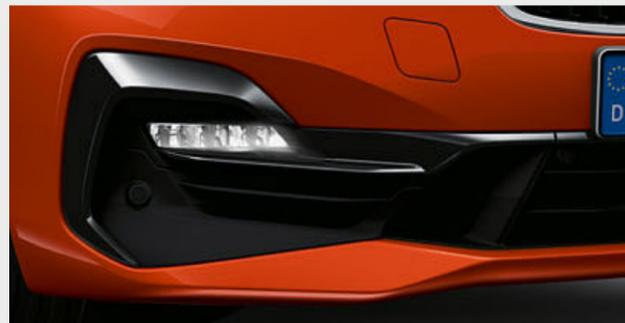
□ Bei Nebel oder Niederschlag sorgen die LED-Nebelscheinwerfer<sup>2</sup> durch verbesserte Sicht im Nahbereich für ein Plus an Sicherheit. Sie zeichnen sich durch eine dem Tageslicht besonders ähnliche Lichtfarbe, eine sehr hohe Lebensdauer sowie einen geringen Energieverbrauch aus und verleihen der Fahrzeugfront ein technisch-modernes Erscheinungsbild.
