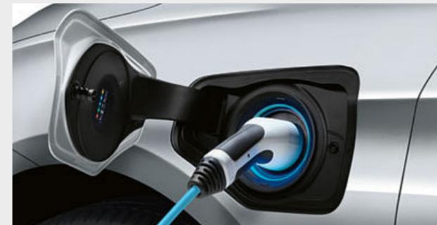
Der Ladeanschluss zum externen Laden der Hochvoltbatterie befindet sich hinter einer Klappe in der linken vorderen Seitenwand des Fahrzeugs. Die Steckdose wird durch einen speziellen Dichttring vor Umwelteinflüssen geschützt. Ein sie umgebender LED-Leuchtring informiert über den momentanen Ladestatus.
