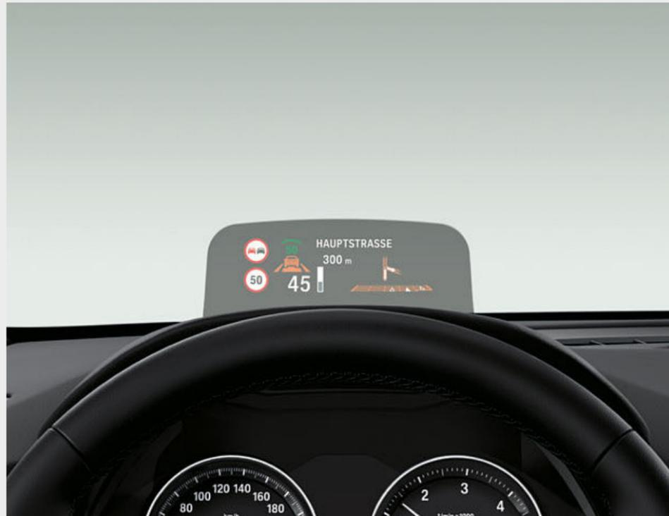
□ Das vollfarbige BMW Head-Up Display<sup>1</sup> blendet alle für die Fahrt relevanten Daten auf eine Projektions-scheibe im Sichtfeld des Fahrers ein und verhindert damit eine längere Ablenkung vom Fahrgeschehen. Es werden u. a. die aktuelle Geschwindigkeit, Hinweise der Navigation, die Speed Limit Info inkl. Überholverbotsanzeige und Telefon- und Entertainmentlisten angezeigt.
