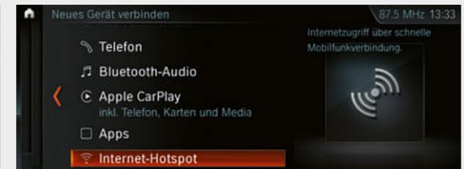
□ Die Ausstattung WLAN Hotspot<sup>6</sup> beinhaltet einen fest integrierten Internet Hotspot mit LTE-Standard, der eine kostenpflichtige Internetverbindung ermöglicht. Die Verbindung erfolgt über die fest im Fahrzeug verbaute SIM-Karte und einen dazugehörigen kostenpflichtigen Tarif der Deutschen Telekom AG.
