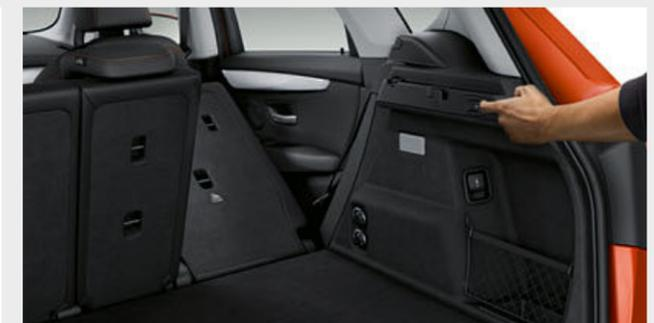
□ Die Lehnenfermentriegelung der Fondsitze<sup>7</sup> ermöglicht das Entriegeln und Umklappen der Rücksitzbanklehne bequem mit einer Taste im Gepäckraum.
