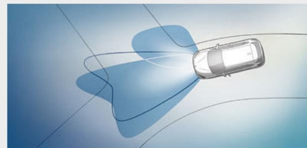
□ Der **Adaptive LED-Scheinwerfer** beinhaltet eine Abblend- und Fernlichtfunktion sowie Fahrtrichtungsanzeiger in Voll-LED-Technologie. Außerdem umfasst die Ausstattung BMW Selective Beam, Abbiegelicht, Tagfahrlicht und Adaptives Kurvenlicht mit variabler Lichtsteuerung für eine optimale Ausleuchtung der Fahrbahn und bessere Sicht bei Dunkelheit.
