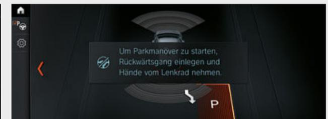
□ Der Parkassistent<sup>9</sup> erleichtert Ihnen das Einparken parallel zur Fahrbahn. Dazu misst das System Parklücken beim Vorbeifahren mit niedrigem Tempo aus. Ist eine ausreichend große Lücke gefunden, übernimmt der Parkassistent das Lenken und Sie begleiten den Einparkvorgang durch die richtige Gangwahl sowie Gasgeben bzw. Bremsen.
