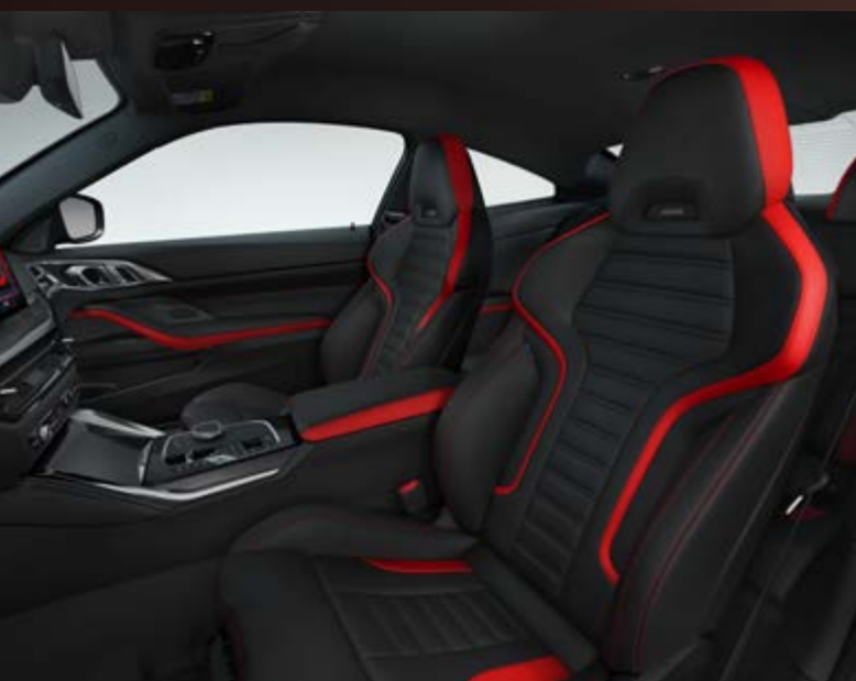
Sportsitze Die Sportsitze für Fahrer und Beifahrer bieten optimalen Seitenhalt durch höhere Sitzwangen und eine manuell einstellbare Oberschenkelauflage. Zudem lassen sich die Sitzlängsrichtung und -neigung manuell verstellen.
