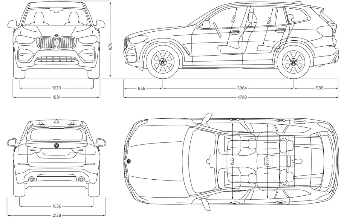
Alle Maßangaben der technischen Zeichnung in Millimeter. Angaben zu Fahrleistung, Verbrauch und CO<sub>2</sub>-Emissionen gelten für Fahrzeuge mit Seriengertriebe.
