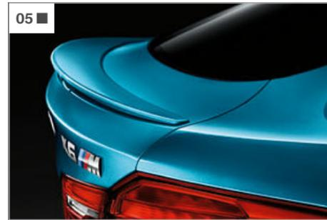
**[ 05 ]** Der funktionale Heckspoiler in Wagenfarbe sorgt für zusätzlichen Abtrieb an der Hinterachse und streckt optisch die Silhouette (nur für BMW X6 M).
