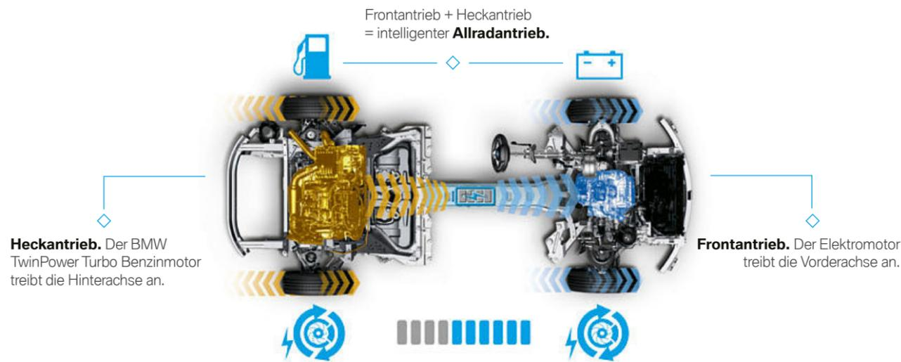
**STEPTRONIC GETRIEBE:** Das 6-Gang Steptronic Getriebe ist an den Benzinmotor gekoppelt und perfekt auf das Plug-in-Hybridsystem abgestimmt. Über den elektronischen Gangwahlschalter kann der Fahrer den Sport-Modus aktivieren, der die Schaltzeiten verkürzt und zudem manuelle Gangwechsel zulässt. Der E-Motor auf der Vorderachse ist an ein zweistufiges Getriebe gekoppelt.
