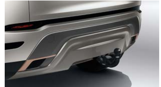
Anhängesystem – Elektrisch ausfahrbare Anhängerkupplung
