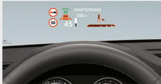
□ Das vollfarbige BMW Head-Up Display<sup>2</sup> blendet per optischer Projektion für die Fahrt relevante Daten in das Sichtfeld des Fahrers ein und steigert damit die Konzentration auf das Fahrgeschehen. U. a. werden die aktuelle Geschwindigkeit, Navigationshinweise, die Speed Limit Info inkl. Überholverbotsanzeige und Telefon- und Entertainmentlisten angezeigt.
