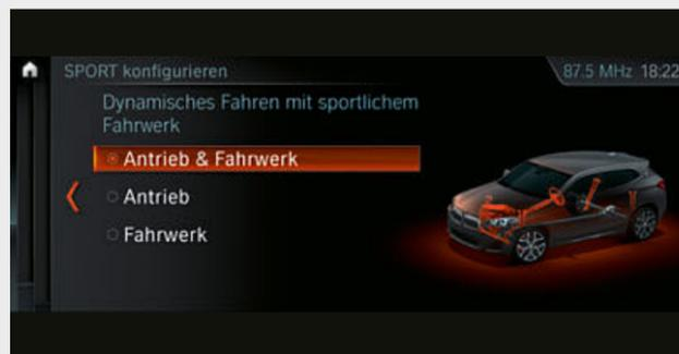
□ Das um zehn Millimeter tiefergelegte Adaptive Fahrwerk ermöglicht eine Anpassung der Dämpfercharakteristik an die Fahrsituation und verbindet Fahrkomfort und Fahrdynamik mit größtmöglicher Sicherheit. Über den Fahrerlebnisschalter kann der Fahrer die Standard-Einstellung COMFORT oder den Modus SPORT vorwählen.
