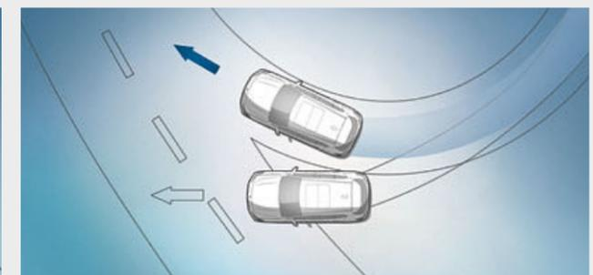
■ Die **Dynamische Stabilitäts Control (DSC)** erfasst permanent den Fahrzustand und stabilisiert das Fahrzeug per Motor- und Bremsenmanagement, falls sich instabile Fahrzustände abzeichnen. Weitere Funktionen der DSC sind z. B. Trockenbremsen, Bremsbereitschaft oder Anfahrassistent, der das Fahrzeug beim Anfahren an Steigungen kurz hält und so ein Rückrollen verhindert.
