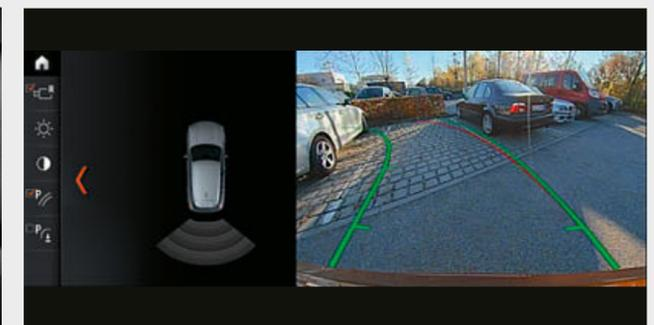
□ Die Rückfahrkamera ermöglicht Ihnen eine bessere Orientierung beim Rückwärtsfahren in Parksituationen und im Geschwindigkeitsbereich von unter 15 km/h. Sie zeigt den Bereich hinter dem Fahrzeug auf dem Control Display an. Interaktive Spurlinien für Abstand und Wendekreis unterstützen Sie beim Rangiervorgang, Hindernisse werden farblich gekennzeichnet.
