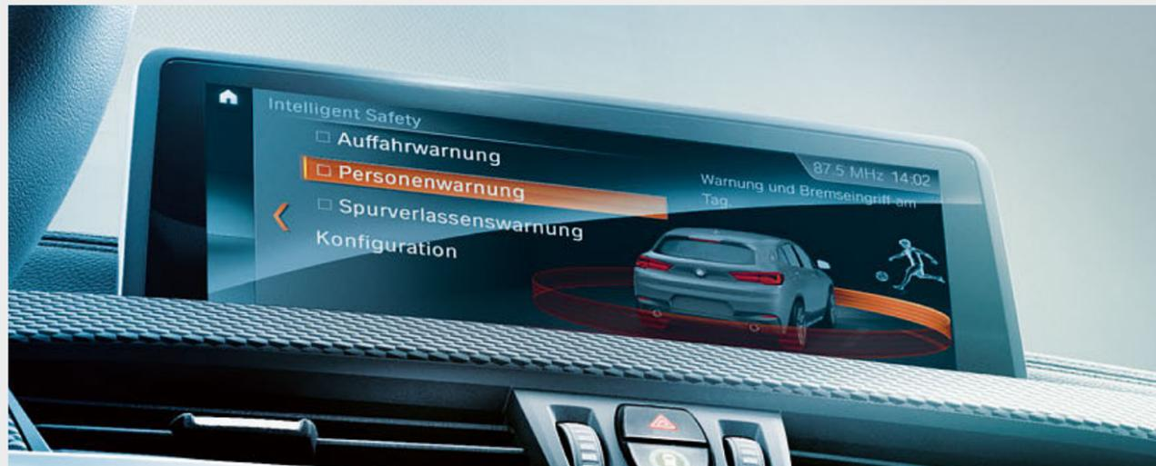
Das Sicherheitspaket **Driving Assistant<sup>1</sup>** warnt Sie vor ungewolltem Verlassen der Fahrspur<sup>2</sup> sowie vor drohenden Kollisionen und bremst im Notfall selbsttätig.
