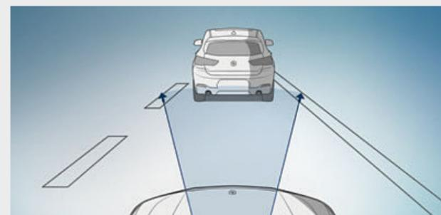
■ Die **Auffahrwarnung mit City-Anbremsfunktion<sup>2</sup>** warnt vor kritischen Auffahrsituationen und kann somit Unfälle verhindern. Bei Kollisionsgefahr mit einem vorausfahrenden oder stehenden Fahrzeug erfolgt eine zweistufige Warnung, gegebenenfalls werden die Bremsen für ein schnelleres Ansprechen vorkonditioniert. Im Notfall leitet das System eine Bremsung ein und sorgt für eine deutliche Verringerung der Aufprallgeschwindigkeit.
