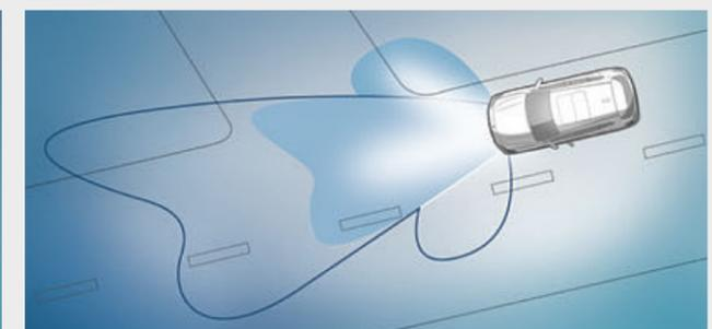
□ Die **LED-Scheinwerfer** mit erweiterten Umfängen bieten u. a. ein lichtstarkes und effizientes Bi-LED-Licht für Abblend- und Fernlicht. Das Abbiege- und Kurvenlicht in LED-Technologie ist ebenfalls integriert und ermöglicht eine variable Lichtverteilung mit erhöhter Seitenausleuchtung im Stadtverkehr und auf Landstraßen.
