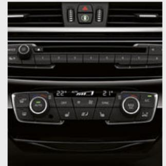
□ Die Klimaautomatik mit 2-Zonenregelung enthält die Automatische Umluft Control (AUC) mit Mikroaktivkohlefilter sowie einen Beschlag- und Solarsensor.
