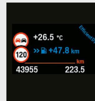
□ Die intelligente Speed Limit Info<sup>9</sup> erkennt per Kamera und Abgleich mit Navigationsdaten aktuell geltende Geschwindigkeitsbeschränkungen.
