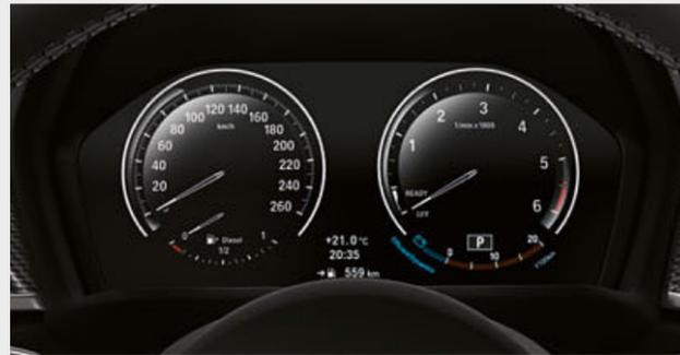
□ Die erweiterten Umfänge der Instrumentenkombination<sup>4</sup> in Black-Panel-Technologie umfassen u. a. ein größeres, hochauflösendes TFT-Display, auf dem Navigationshinweise, Bedierrückmeldungen sowie verschiedene Fahrzeuginformationen wie Senderlisten, Musiktitel oder Telefonbucheinträge eingeblendet werden können.
