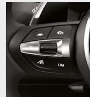
□ Der Driving Assistant Plus<sup>7</sup> bietet Ihnen Warn- und Kollisionsschutzfunktionen, die kamerabasierte Geschwindigkeitsregelung und den Stauassistenten.
