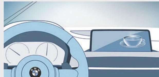
■ Der **Aufmerksamkeitsassistent** prüft das Verhalten des Fahrers auf Anzeichen von Müdigkeit wie z. B. ungenaues Spurhalten. Das System analysiert das Lenkverhalten und reagiert auf Auffälligkeiten: Im Control Display erscheint gegebenenfalls eine Pausenempfehlung, damit Gefahrensituationen gar nicht erst entstehen.
