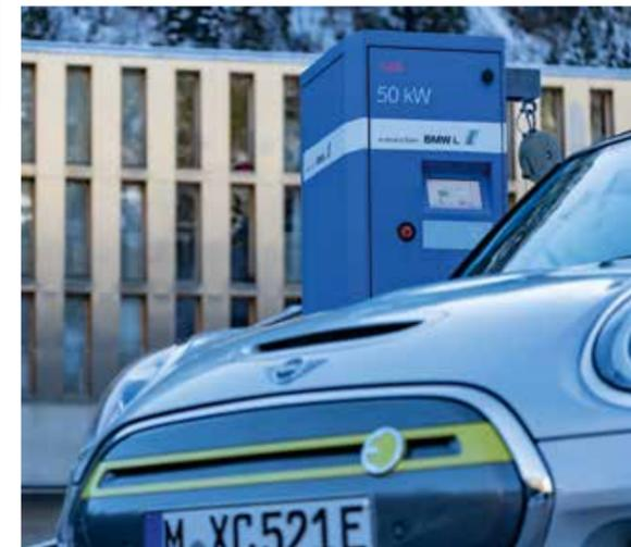
Der MINI Cooper SE kann mit bis zu 50 kW versorgt werden und benötigt so nur 35 Minuten, bis er zu 80 Prozent geladen ist. Zuhause an der Wallbox dauert die komplette Ladung maximal 4,2 Stunden.
