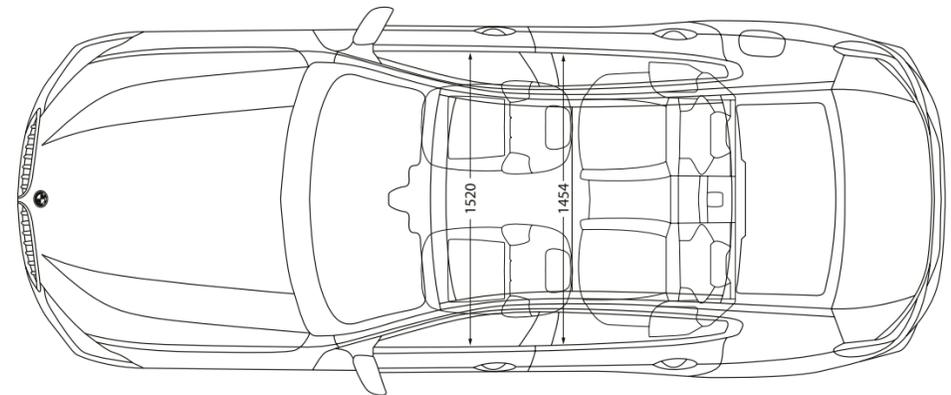
Die Maßangaben der technischen Zeichnung beziehen sich auf den M850i xDrive, Maße des 840i, 840i xDrive und 840d xDrive können leicht abweichen. Alle Maßangaben der technischen Zeichnung in Millimeter.
